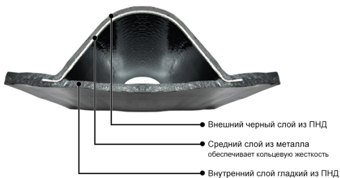
Рисунок 2. Структура FDplast ARM
